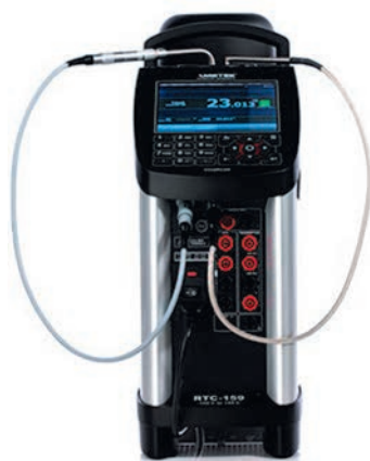
Рис. 2. Калибратор RTC-159B с эталонным термометром Pt100 и датчиком DLC
