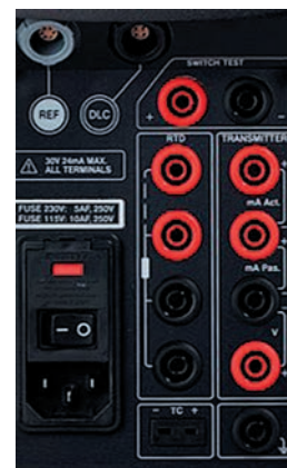
Рис. 4. Передняя панель калибратора RTC исполнения В с клеммами для измерения сигналов поверяемых датчиков
