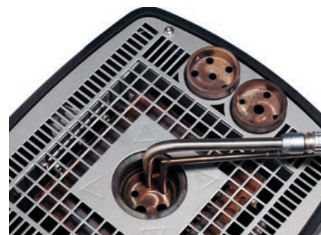
Рис. 3. Вставная трубка для установки датчиков различных диаметров
