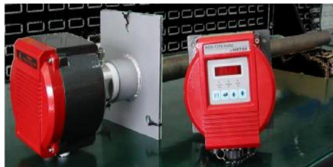
Рисунок 2 - Общий вид анализаторов модели WDG-1210 Insitu
